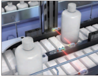
複数列のベルトコンベア上のボトルの通過有無を確認
