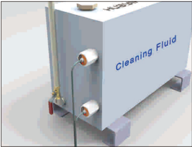
洗浄液タンク内液位検査
